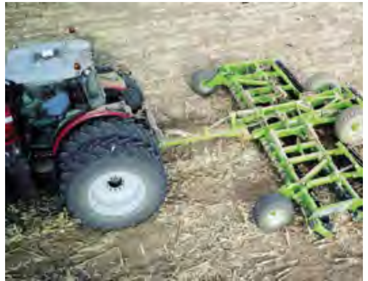
Die skottelwerktuig van 6 m aan die werk. Die werktuig se wydte word tot sowat 2 m verminder wanneer die kante met hidrouliese arms opgelig word.
