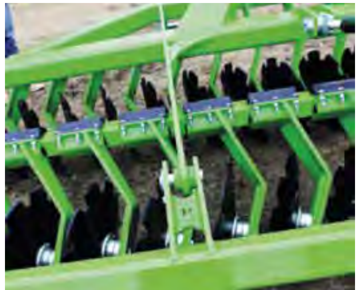
Die BOK-I het 'n geïntegreerde raam/roller-ontwerp wat die hele werktuig stabiel maak.
