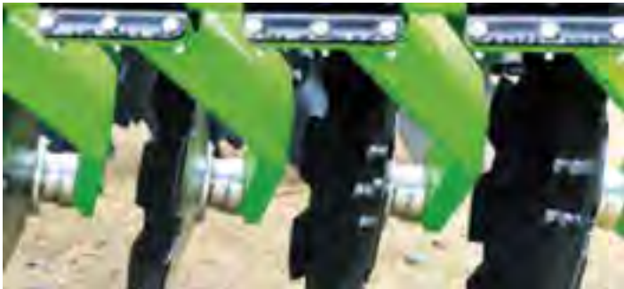
Die hoek van die skottels wat voldoende vloei van materiaal deur die werktuig verseker. Die skottelgange is ook ver uit mekaar geplaas sonder om die massamiddelpunt van die werktuig prys te gee.
