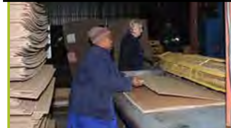
“Platen Die Cutter” karton word gesny en gevou.
