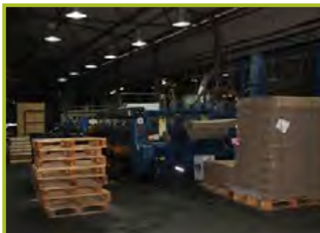
“Platen Die Cutter” karton word gesny en gevou.
