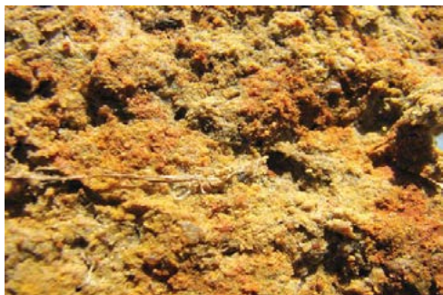
Figuur 3: Vlekke en beweging van yster dui op versuip-toestande. Die grys dele is ontyster en die rooi dele is verryk met yster.
